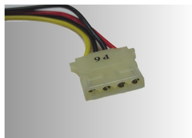
fig 2: De stekker die er afgeknipt dient te worden
